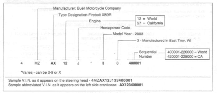
Figure 2-3. Vehicle Identification Number (V.I.N.)
