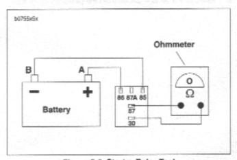
Figure 5-6. Starter Relay Test
