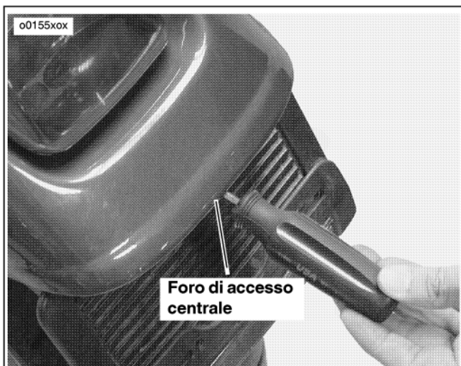
Figura 20. Foro di accesso per la rimozione della luce posteriore (modelli FXSTD/I)
