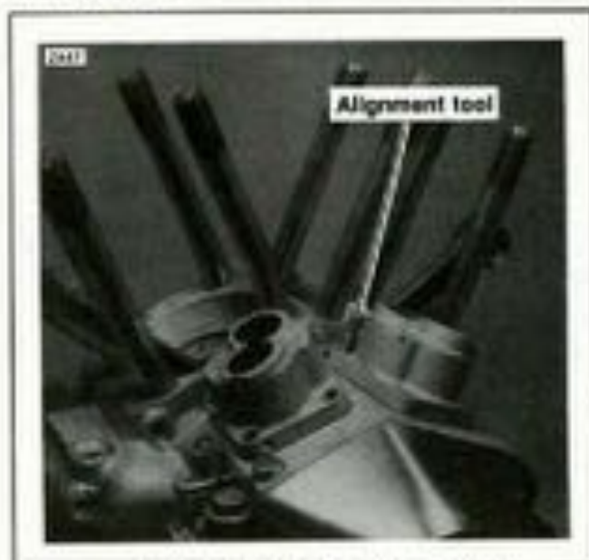
Figure 3-27. Aligning Tappet Guide
